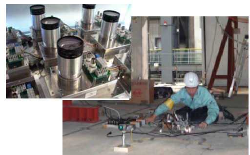
試作層間変位センサと実建物の地震応答計測実験
